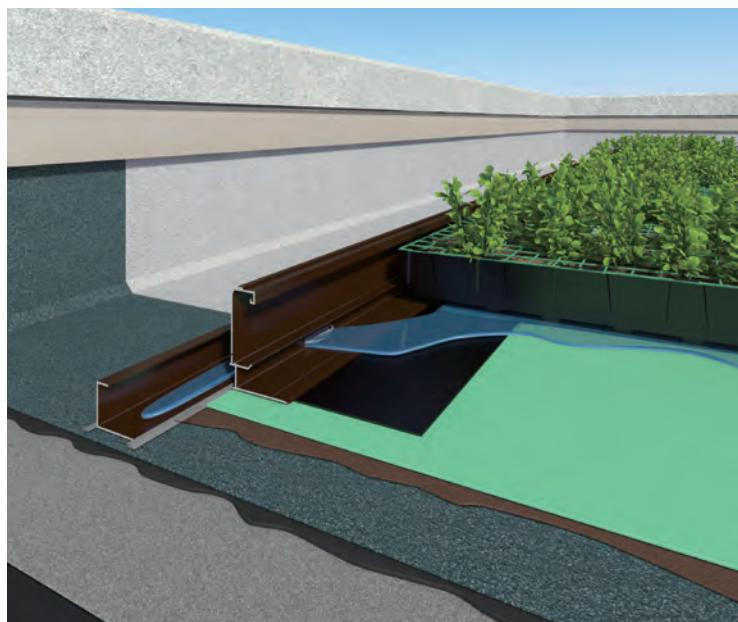
屋上植栽の周囲では、藻類の発生や、堆積などの影響で、屋上景観を低下させる事例がおこることがあります。自動灌水装置を設置した事例では発生の可能性が高くなるようです。直ちに防水層に悪影響を及ぼすものではありませんが、放置しておくと防水層表面砂の剥離に繋がります。対策として植栽見切材の周囲にアルミ製排水ガイドを取り付けることで緩和することができます。
